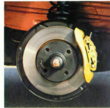
Der Porsche 924 besitzt selbstverständlich eine Zweikreis-Diagonal-Bremsanlage. An den Vorderrädern arbeiten Schwimmrahmen-Scheibenbremsen.
